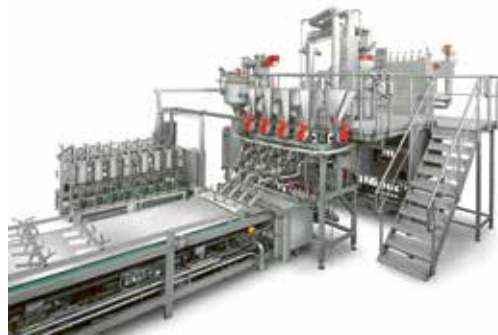
Hartbonbonanlage Sucroliner® von Hänsel Processing GmbH
